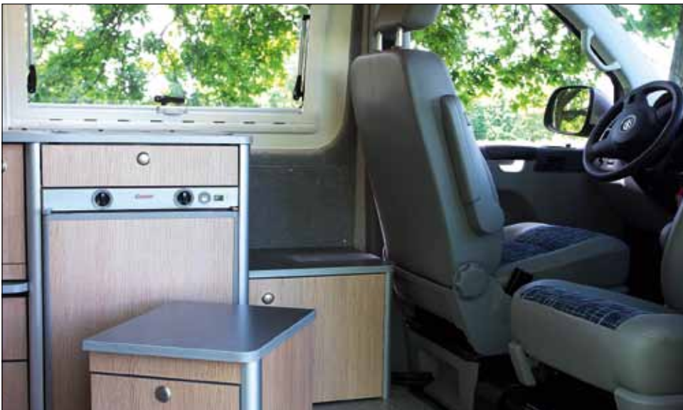
Herausnehmbares Klappenmodul: Schafft viel Platz für den Fahrer und kann als Hocker oder Beinauflage genutzt werden.
